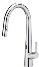
Mezclador monomando electrónico para cocina con caño curvo giratorio, ducha de 2 funciones extraíble y apertura en agua fría.
